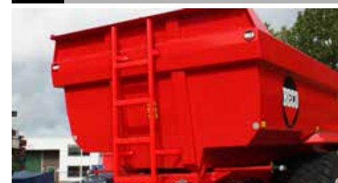
D110 Leiter an der Stirnwand der Mulde
